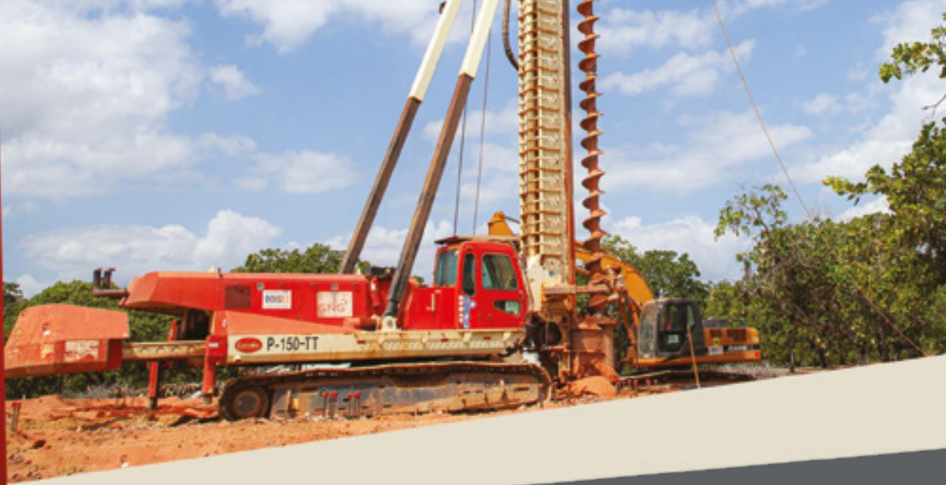
A frota de perfuratrizes hidráulicas é um dos diferenciais da GNG no mercado de construção civil. Ao todo, oito desses equipamentos são utilizados para a execução de estaca hélice contínua, garantindo agilidade e eficiência aos serviços, além de prazos de entrega reduzidos.
