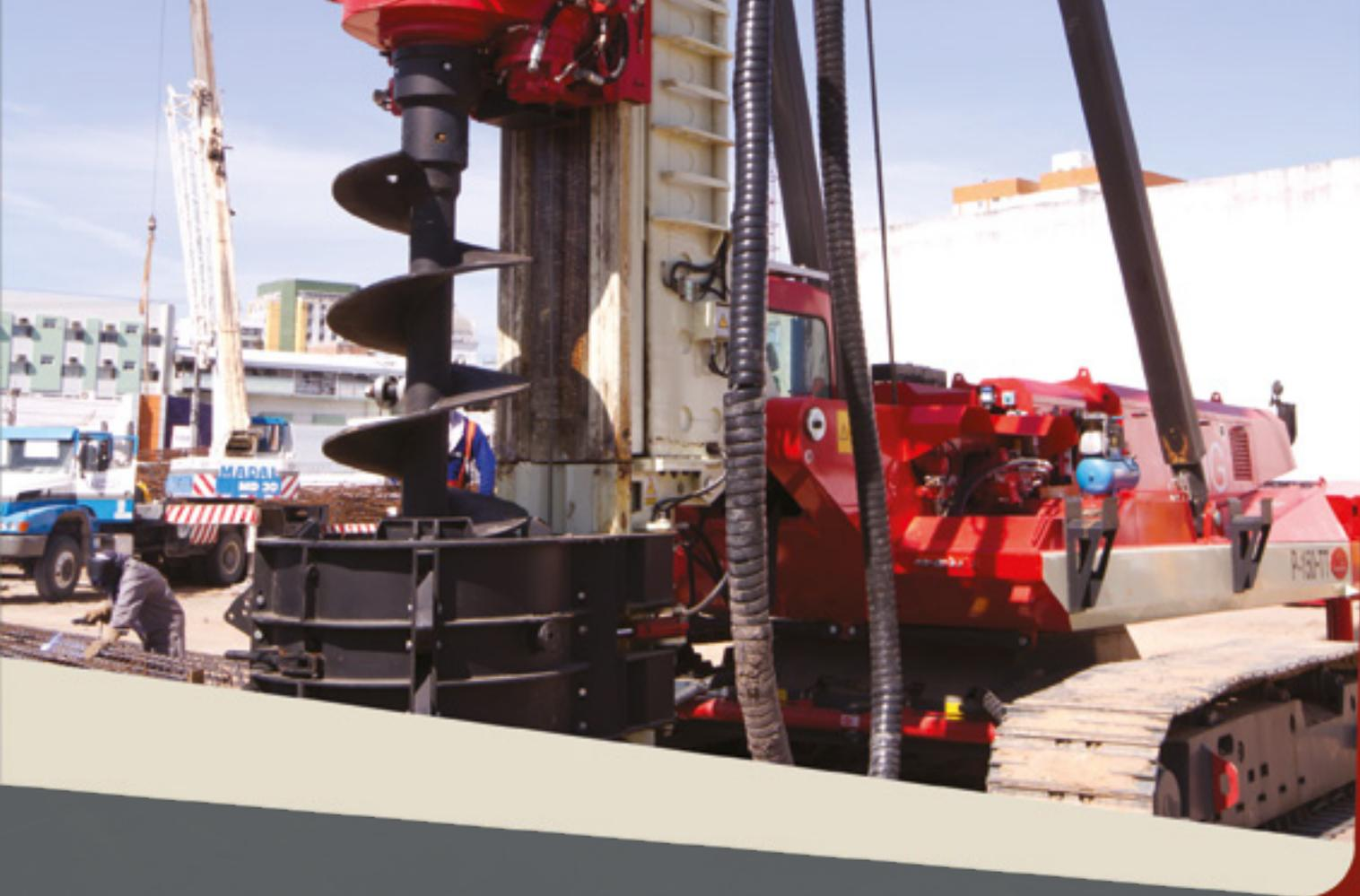
Em seu parque de equipamentos, a GNG possui a perfuratriz mais potente e profunda da LLAMADA, uma das maiores especialistas mundiais em equipamentos do segmento, capaz de atingir até 30.000mm de profundidade, sem auxílio de prolongadores. Com um torque de 45t\*m, o equipamento é capaz de perfurar terrenos com presença de rocha e alteração de rocha, com diâmetros de 400mm até 1.200mm, contemplando projetos de diversas proporções.
