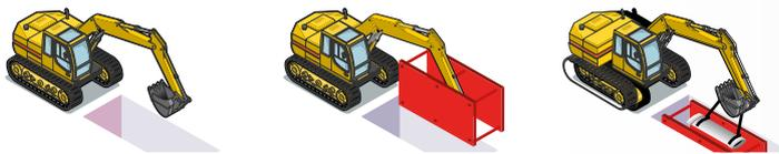
O processo de aplicação é rápido, basta realizar uma pré escavação; encaixar a Blindagem; finalizar a abertura da vala e iniciar o trabalho.
