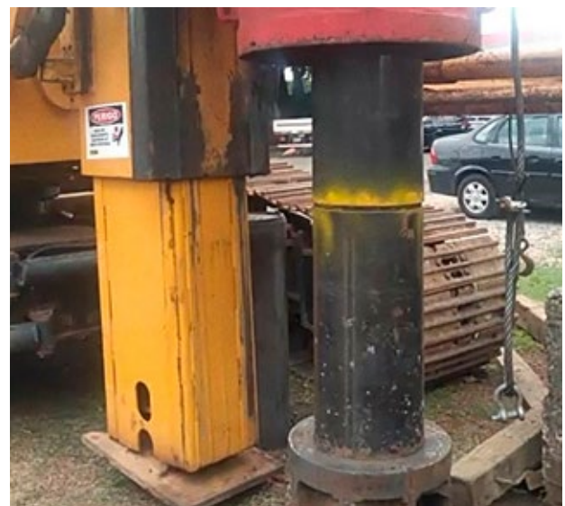
Figura 7.28 – Montagem de amostras para testes da conexão rápida.
